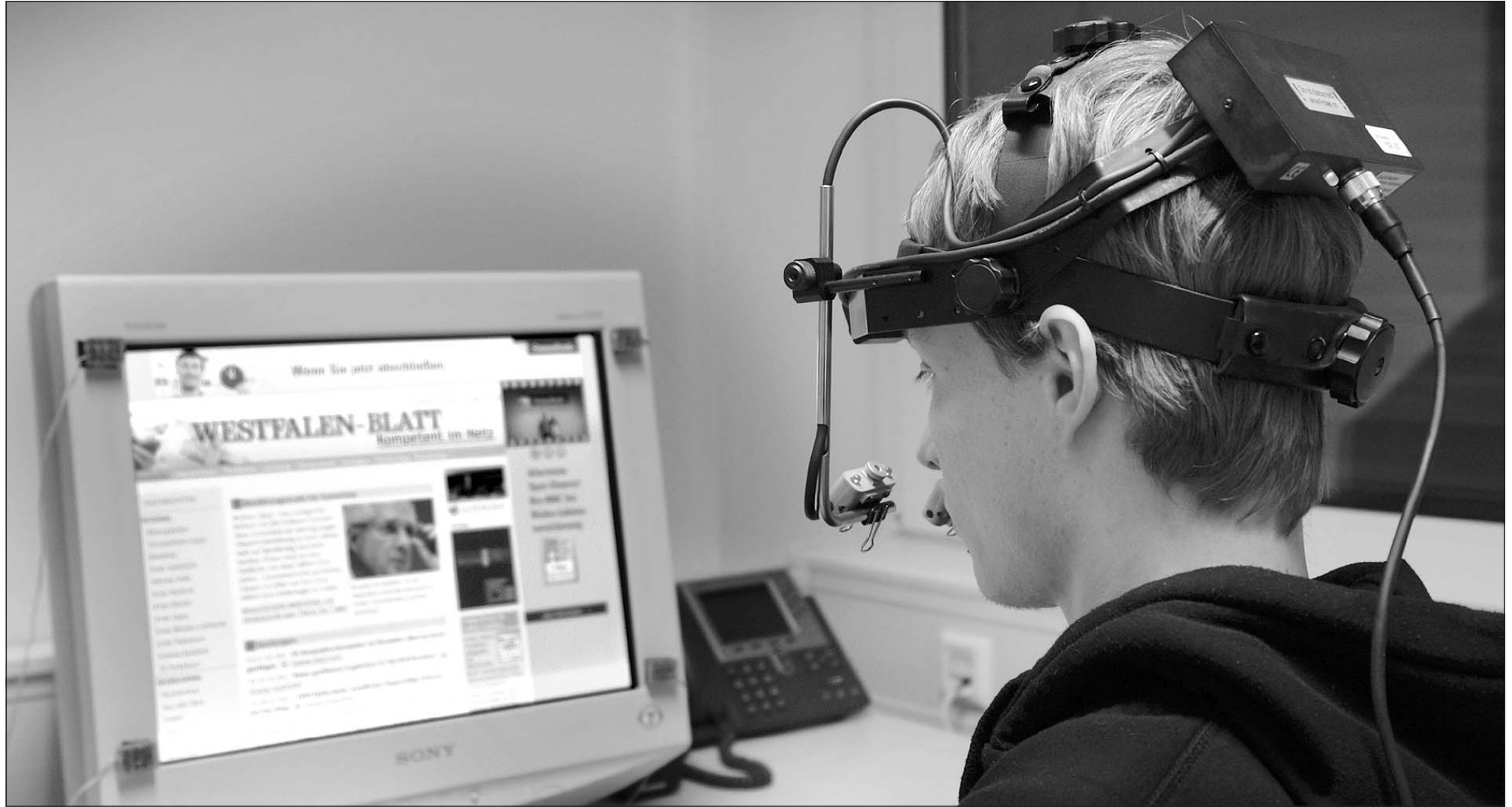
Beim Eye-Tracking, auch Blickbewegungs-Registrierung genannt, geht es um die Aufzeichnung von Blickbewegungen einer Person. Mit Kameras, die mittels eines Gestells am Kopf befestigt (Foto) oder direkt am Bildschirm montiert sind, wird aufgezeichnet, wann, wo und wie lange ein Internetnutzer mit seinem Blick auf der Seite verweilt.
